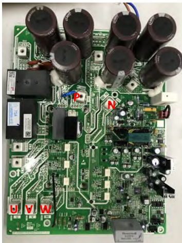
Figura 76: Método de conexão do fio de detecção CC (220 V)
