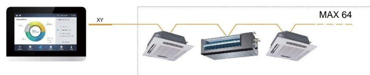
Figura 7(b). Conexão do controlador central à unidade interna (IDU CA/CC de 1ª geração)
