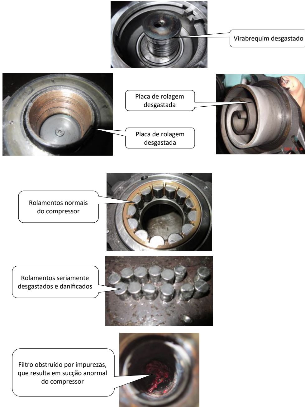
Figura 64: Efeitos do óleo deteriorado do compressor
