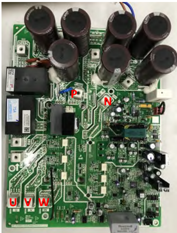
Figura 53: Terminais do módulo inverter (220 V)
