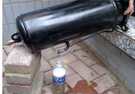
Figura 61: Drenagem do óleo de um compressor
